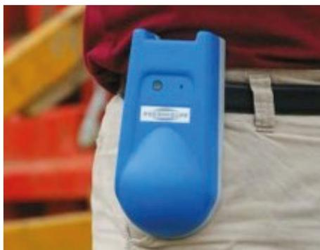
Beispiel eines Dosimeters am Hosengurt getragen.
