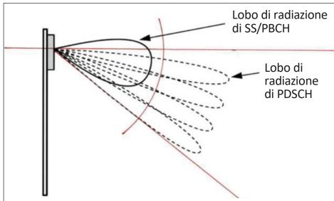
Rappresentazione schematica (vista laterale del diagramma di radiazione verticale di una cella di una stazione base NR)
