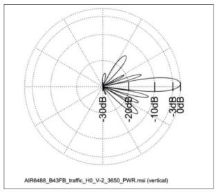
Diagramma d'antenna verticale di un'antenna 5G adattiva come allegato alla maggior parte delle domande di costruzione.
