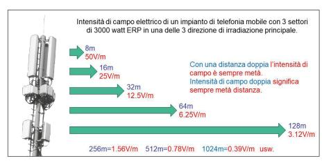
Questo grafico mostra l'intensità di campo elettrico generata da un'antenna trasmittente con un ERP tipico di 3000 watt e a quale distanza.
