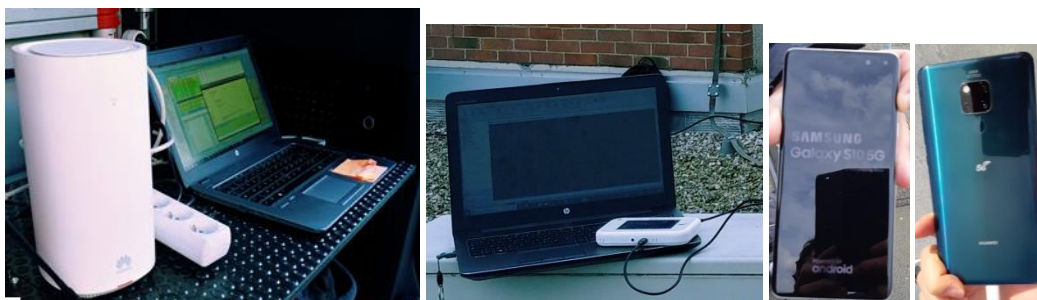
Figure 3 : différents équipements servant de récepteurs sur les pilotes 5G. De gauche à droite, un CPE « customer premises equipment », un modem 5G et deux mobiles 5G.
