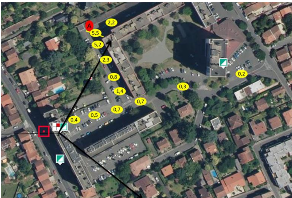
Figure 12 : vue satellite du site de Toulouse avec en rouge la position du CPE et en jaune les niveaux de champ mesurés en en V/m en différents points pour une émission continue sur 100 MHz de largeur de bande avec une puissance maximale de 200 W.
