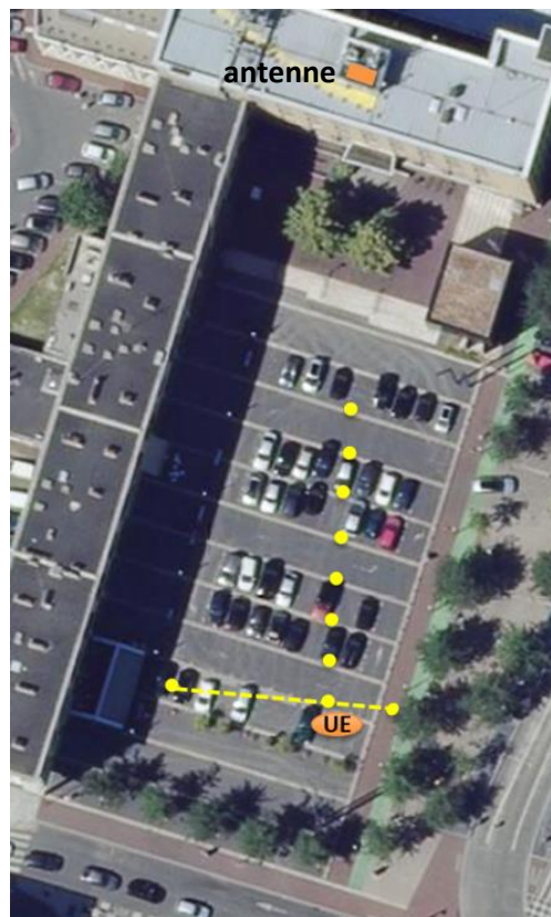
Figure 18 : vue satellite du site de Douai avec l'antenne sur un toit d'immeuble, le modem 5G sur un parking (point orange) et les points de mesure en jaune.
