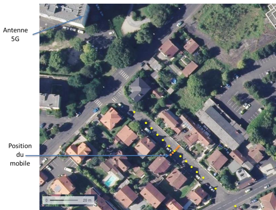
Figure 16 : vue aérienne du site de Pau avec les antennes sur un immeuble à 45 m de hauteur et le CPE situé à 125 mètres de l'antenne, en vue directe dans une rue au pied de l'immeuble supportant les antennes. Les points jaune et orange sont les points de mesure.
