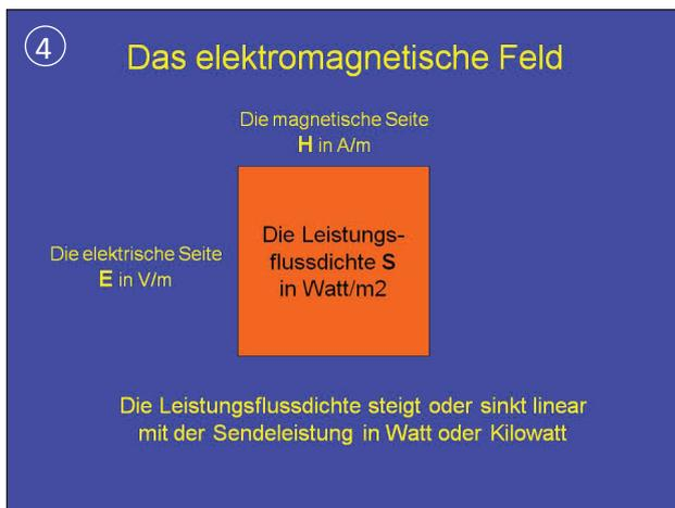
**Bild 5:** Wenn wir nun die elektrische Seite verdoppeln, wächst die Leistungsflussdichte um das 4-Fache, was einer 4-fachen Sendeleistung entspricht.
